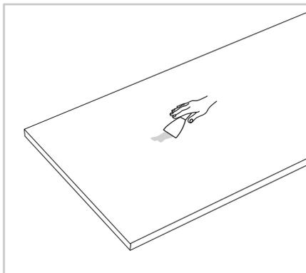
Riempire la superficie danneggiata con il prodotto fornito (stucco poliester), coprendo bene la superficie con una spatola metallica.
