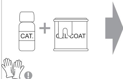
Verter los dos botes en el vaso de precipitados y homogeneizar la mezcla con la espátula.
