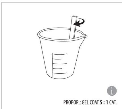
Versez les deux bocal dans le bécher et homogénéisez le mélange avec la spatule.
