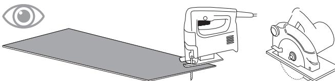
**Cortar o ajustar las medidas del panel si es necesario. |**
