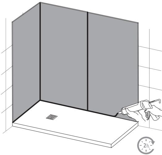
**Siliconar entre los paneles y entre el plato y los paneles.**
