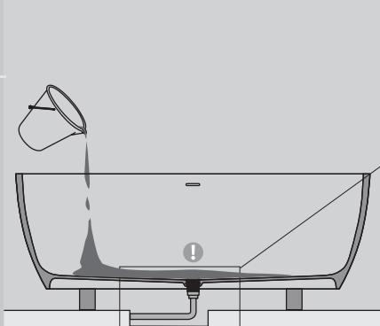
Para comprobar que la instalación se ha efectuado correctamente, cerraremos la válvula y procederemos a llenar la bañera con un poco de agua.
