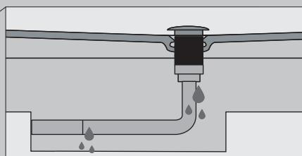
Per verificare che l'installazione sia stata effettuata correttamente, chiudere la valvola e riempire la vasca con un po' d'acqua.
