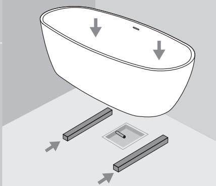
Preparar el espacio, colocar dos listones de cierta resistencia en el suelo, apoyar posteriormente la bañera con la válvula conectada.
