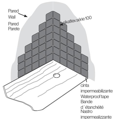
**Colocar el plato en un lugar destinado a tal efecto haciendo coincidir el agujero del plato con el desagüe que previamente hemos colocado en el suelo.**
